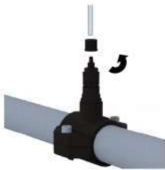
Dévisser l'écrou du clapet d'injection.
