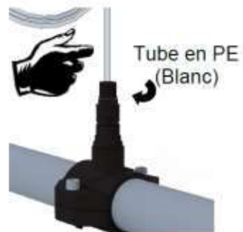
Visser le bouchon avec le tube PE (Blanc) sur le clapet.
