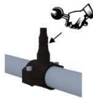
Serrer le clapet d'injection sur le raccord.
